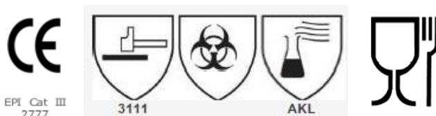
Nota: 1. Los números 3111 indican los niveles de prestación obtenidos en los ensayos de abrasión, corte, rasgado y perforación. Van de 1 a 4, siendo 4 el mejor, salvo en la resistencia al corte donde los niveles van del 1 al 5. 2. Los códigos «A», «K» y «L» designan los compuestos químicos para los cuales se ha obtenido al menos clase 2 en el ensayo de resistencia a la permeación. A: Metanol, K: Hidróxido sódico y L: Ácido sulfúrico 96%.
