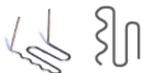
Usando la grapa UNIPLAST nº 9 FUS 0,8mm con el KIT UNIPLAST o NANOPLASTIC puede reparar y reforzar todas las partes de plástico del coche como parachoques, paneles de instrumentos, soportes de faros, carenados, etc.
