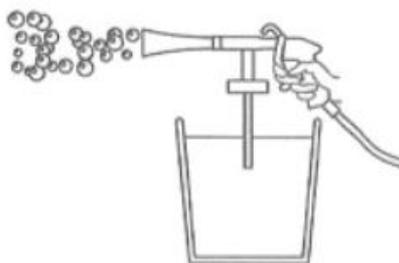
2. Mettre la partie du cône dans le seau et appuyez sur la gâchette du pistolet pendant une minute.
