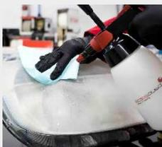
1. Nettoyer soigneusement le phare et sécher-le avec un chiffon propre.
